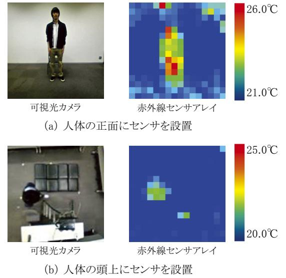
図1 人体を可視光カメラと赤外線センサアレイで撮影した例
