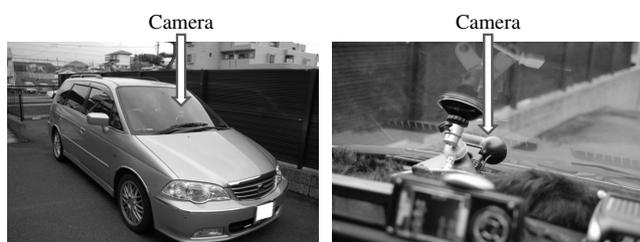
図 6 車載カメラ搭載の様子
